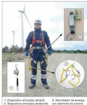
Figura 1. Operario equipado con arnés, absorbedor de energía con doble elemento de amarre, dispositivo anticaída deslizable para línea de anclaje rígida, casco de seguridad, botas de seguridad, linterna frontal para zonas de baja iluminación.
